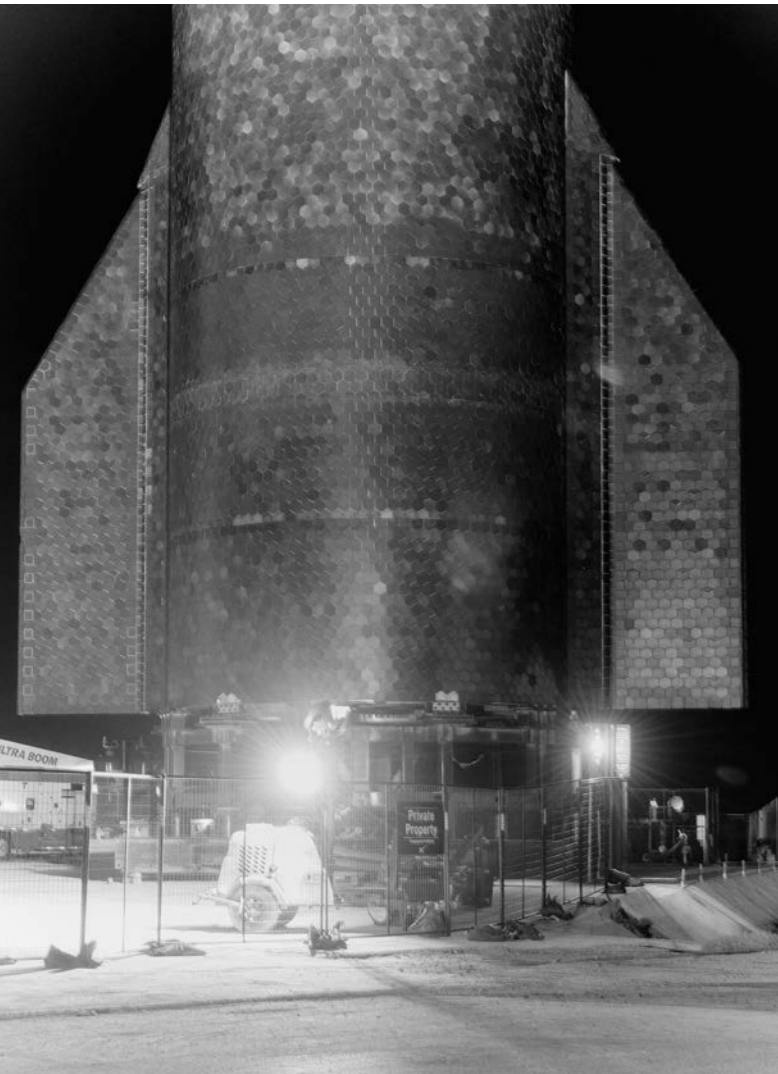
Auf der Raketenhülle sind tausende Hitzekacheln angebracht. Sie sollen sie beim Wiedereintritt in die Erdatmosphäre vor dem Verglühen schützen
